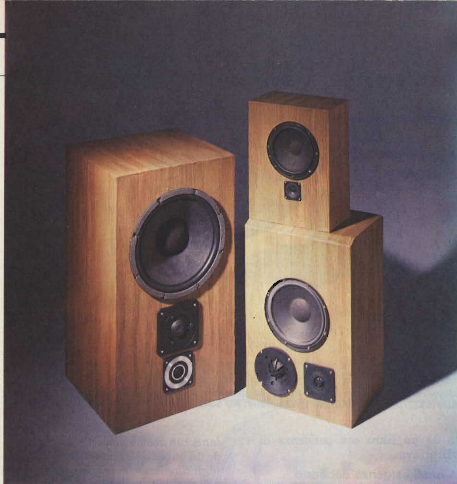
Esempio di casse acustiche completamente chiuse, realizzate nel nostro laboratorio con altoparlanti Philips.
