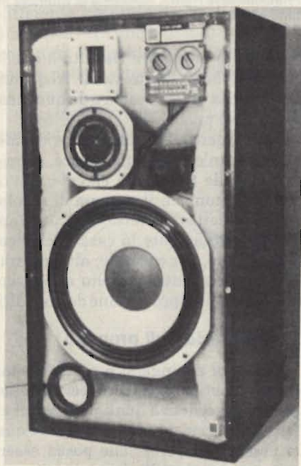
Fig. 4 - Esempio di cassa acustica bass-reflex da 120 W. La parete anteriore è trasparente e consente quindi un'osservazione dell'interno della cassetta. La cassa contiene un altoparlante per i toni bassi (woofer) CS 32 AW, un altoparlante per i toni intermedi DMS 15 AW e un altoparlante a nastro RHT 9.10.
